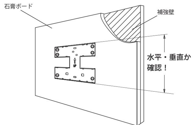
印の箇所にドリルを使用して下穴を開けます。ズレないように十分に気を付けて作業を行ってください。
